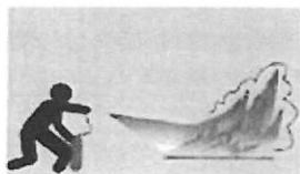
Nel caso di combustibili solidi l'angolo d'impatto deve risultare più accentuato per migliorare la penetrazione della polvere estinguente all'interno delle zone di reazione. In ogni caso si dovrà prestare attenzione perché l'effetto dinamico dell'estinguente potrebbe causare la proiezione di parti calde e infiammate generando la nascita di altri focolai.
